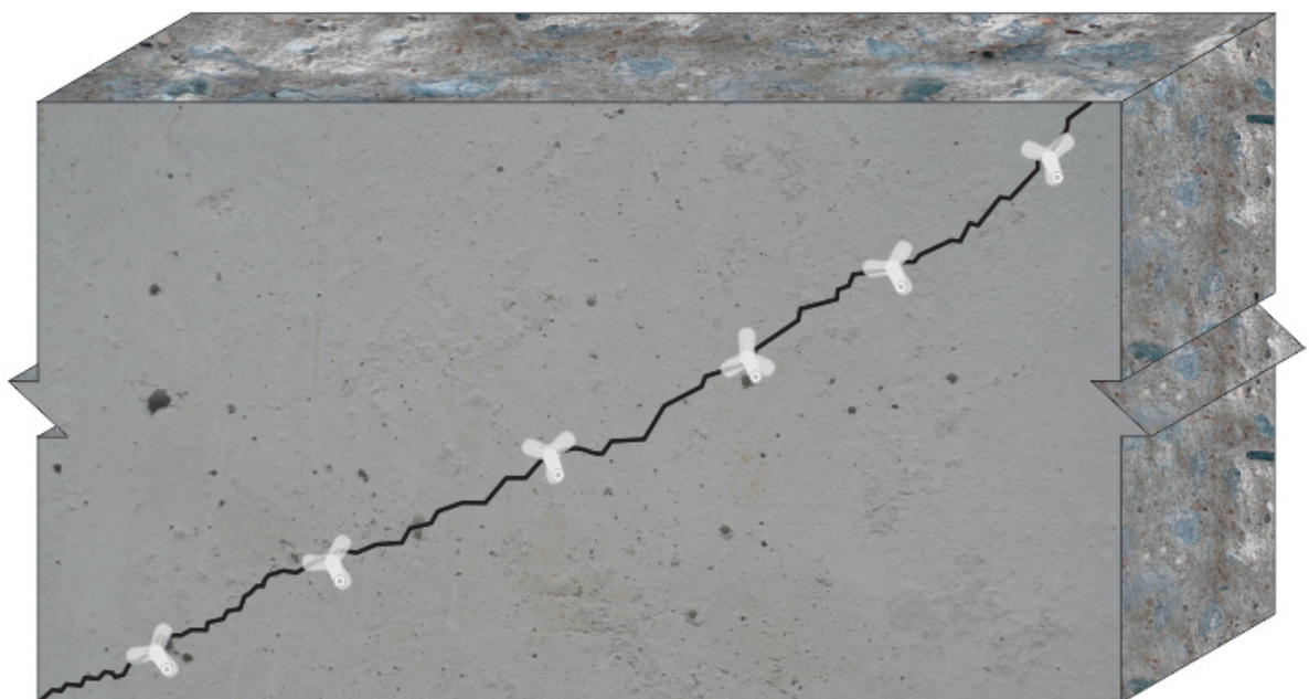
DRILLING & PUMP WITH INSTALLATION ALONG CRACKING KHOAN & ĐẶT ĐẦU BƠM DỌC VẾT NỨT (MỖI ĐẦU CÁCH 200mm)
