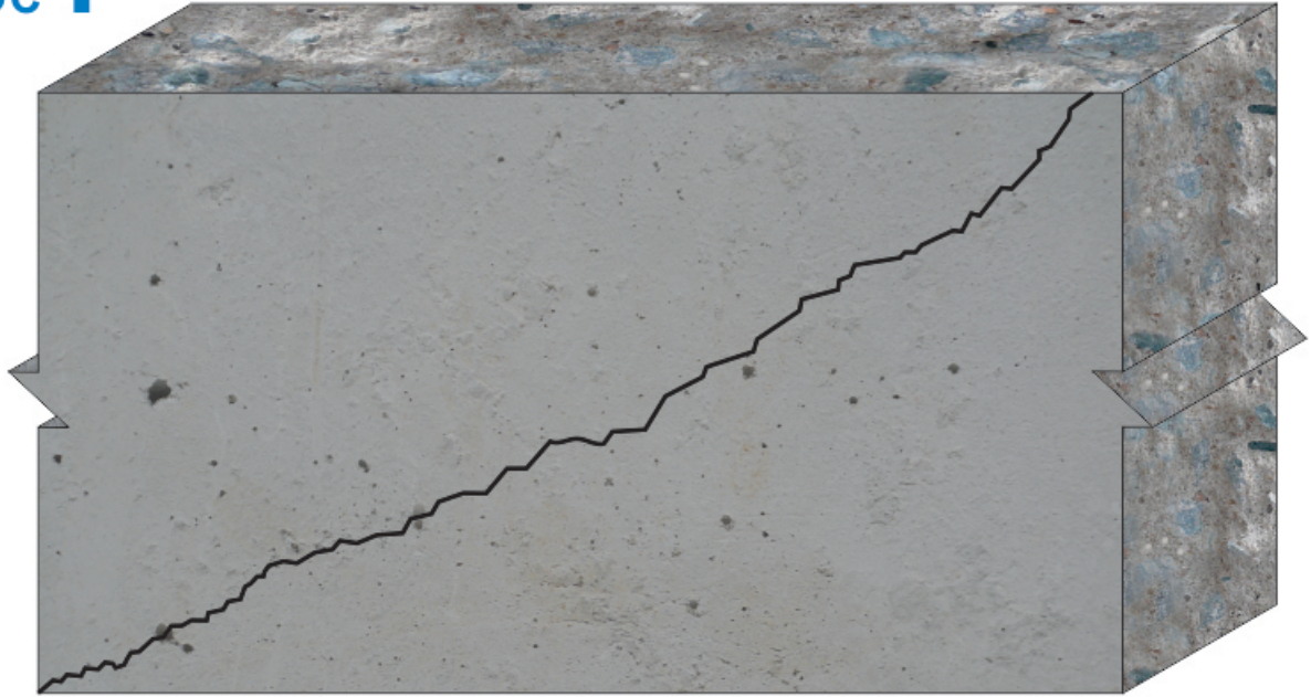
CRACKING IN WALL KHE NỨT TƯỜNG ĐỨNG
