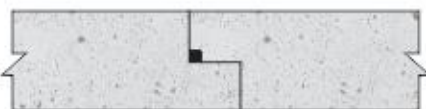
HYPERSTOPS DB Application for Construction Joint Lắp đặt băng cản nước HYPERSTOPS DB cho mạch ngừng
