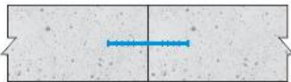
Internal Construction Joint PVC WATERSTOPS Lắp đặt băng cản nước PVC WATERSTOPS cho chính giữa mạch ngừng
