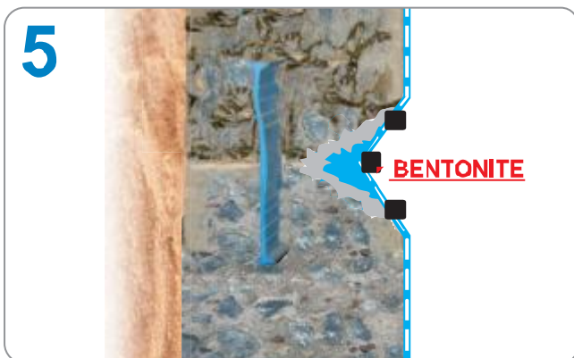
5 INSTALL BENTONITE HYPERSTOP LẮP ĐẶT BẰNG CÁN NƯỚC BENTONITE HYPERSTOP
